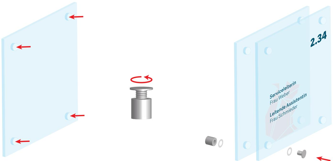
Richten Sie die Scheibe in der gewünschten Höhe an der Wand aus und markieren Sie sich die Bohrlöcher.
