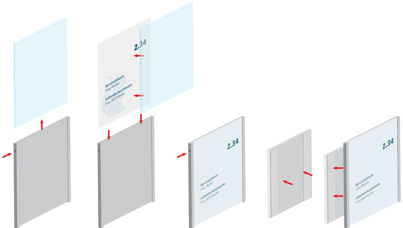
Lösen Sie die seitliche Madenschraube des vormontierten Türschildes und ziehen Sie die Acrylglasscheibe nach oben raus.
