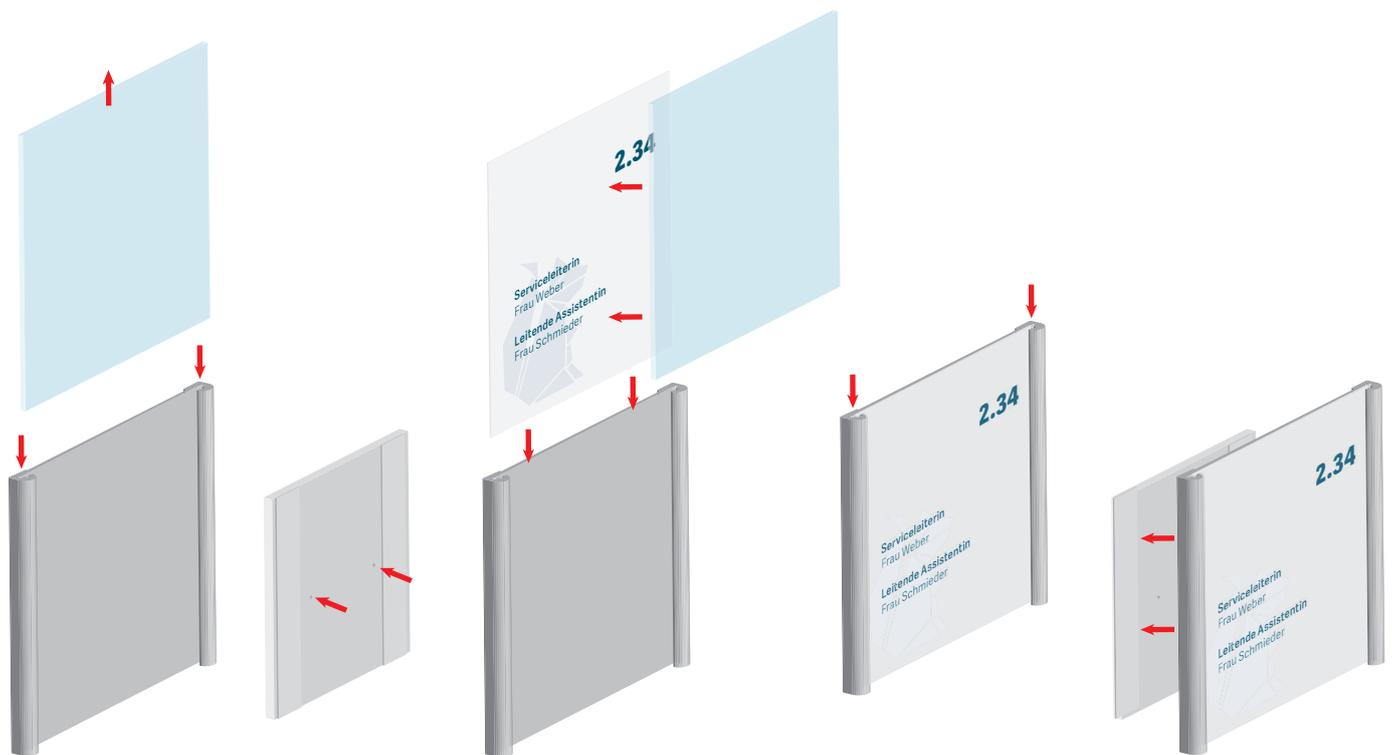
Lösen Sie die beiden oberen Schrauben des vormontierten Türschildes und ziehen Sie die Acrylglasplatte nach oben raus.
